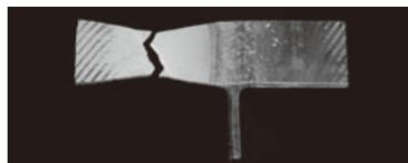
電気亜鉛めっき鋼板
