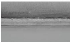
電気亜鉛めっき鋼板
